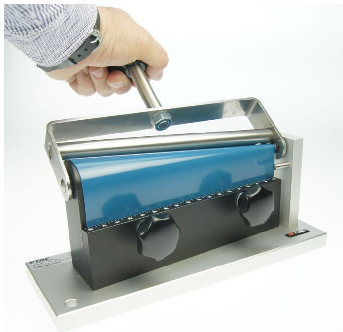
شکل ۱۰-۴: تست خمش با ماندل مخروطی.
