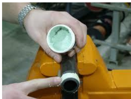
شکل ۴-۹. نمونه عایق الکتریکی خمیری و جامد.
