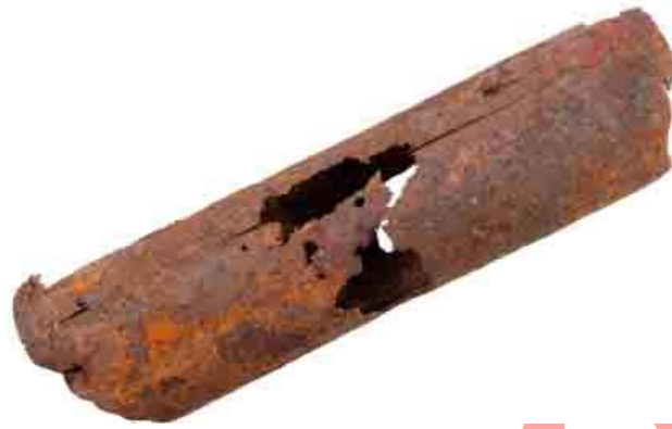
شکل ۲. شکل شماتیک از فرایند خوردگی و یک نمونه لوله آبدۀ خورده شده توسط مکانیزم الکتروشیمیایی.
