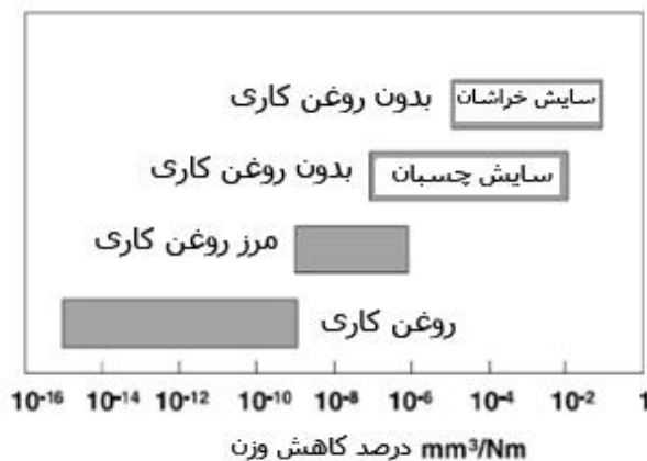
شکل ۱۶-۲- تغییر نرخ ساییش ویژه در مواد فلزی در شرایط روغن کاری متفاوت [۵۶].
