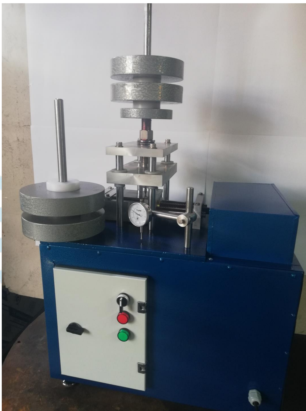
شکل ۱. تصویر دستگاه مقاومت به خراش gouge.
