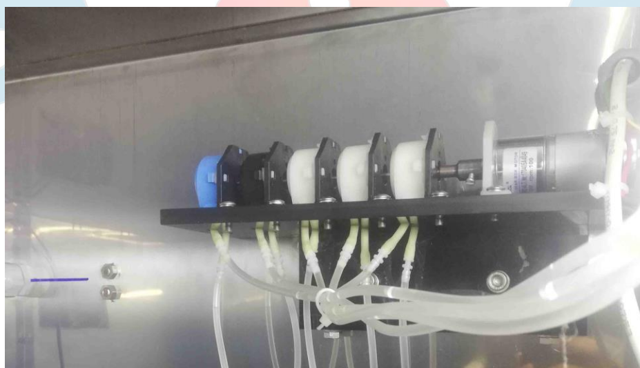
شکل ۳. موتور پرستالتیک دستگاه
