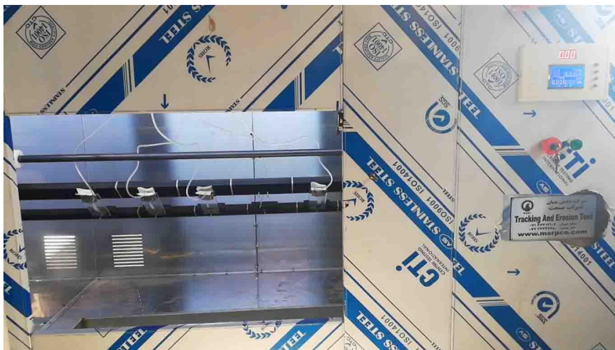
شکل ۱. تصویر دستگاه بررسی رفتار عایقی مواد
