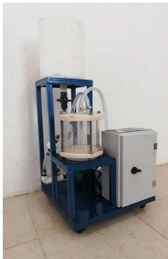
شکل ۳. دستگاه آزمون پاشش سیال.
