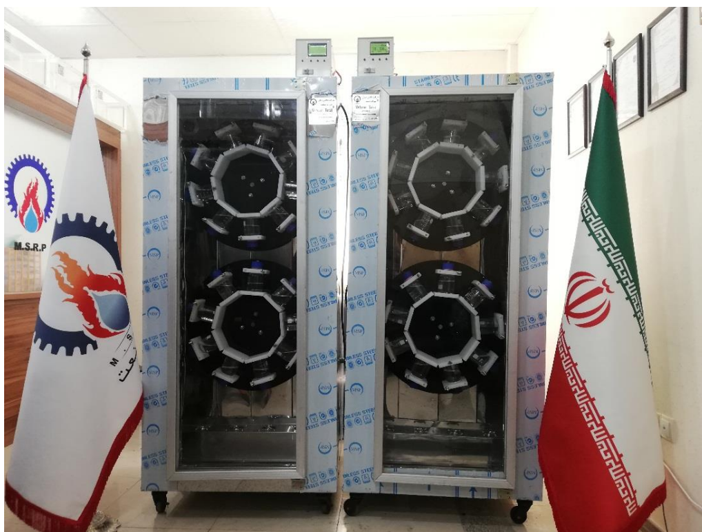
شکل ۱. دستگاه آزمون ویل تست
