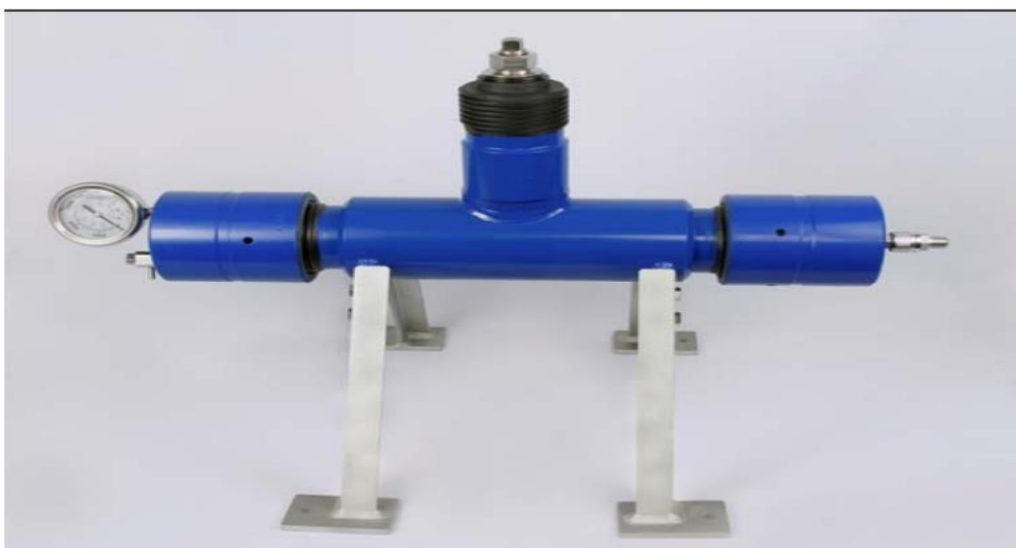
شکل ۲- پایه تست فشار نمونه‌های فلزی
