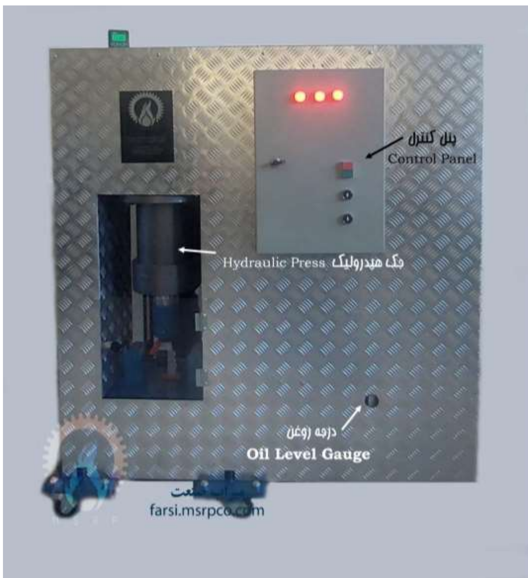
شکل ۱. اجزای دستگاه آزمون نفوذ پذیری
