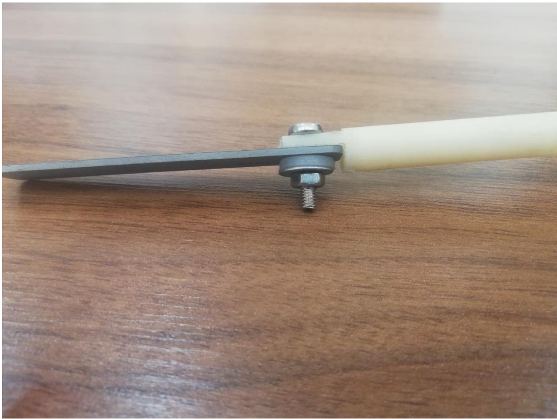
شکل ۳. اسمبلی اینسولیتور و کوپن
