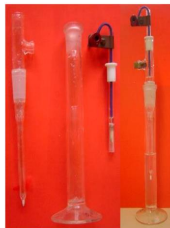
شکل ۴. مقطع شماتیک یک الکتروود مرجع ساده سولفات جیوه-جیوه
